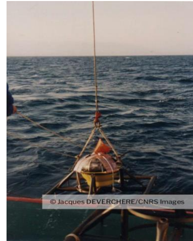
Figure 1 : Sismographe sous-marin (OBS) lors de sa mise en mer
